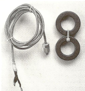
写真2 テフロン同軸はブチルテープで防水する。コアは200mmのインシュロックタイで固定し、接合部分をエポキシ系接着剤で固める
