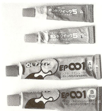
写真3 エポキシ系接着剤は主剤と硬化剤をよく混合して使う。固まっても体積は変わらないが温度によって硬化時間がまちまち
