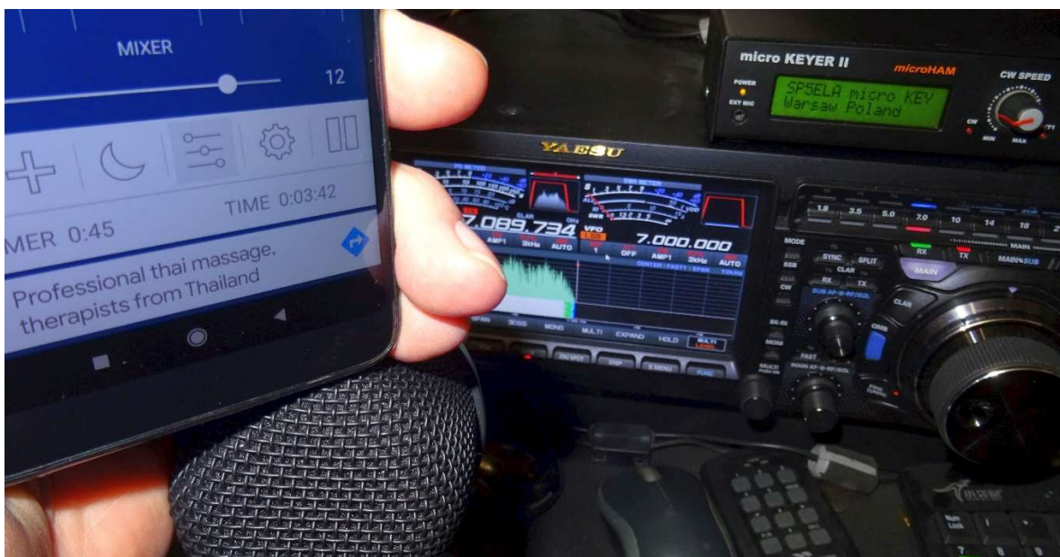
„Zestaw” pomiarowy: smartfon, mikrofon, TRX. Widoczny ekran TRX-a z sygnałem wyjściowym RF.
