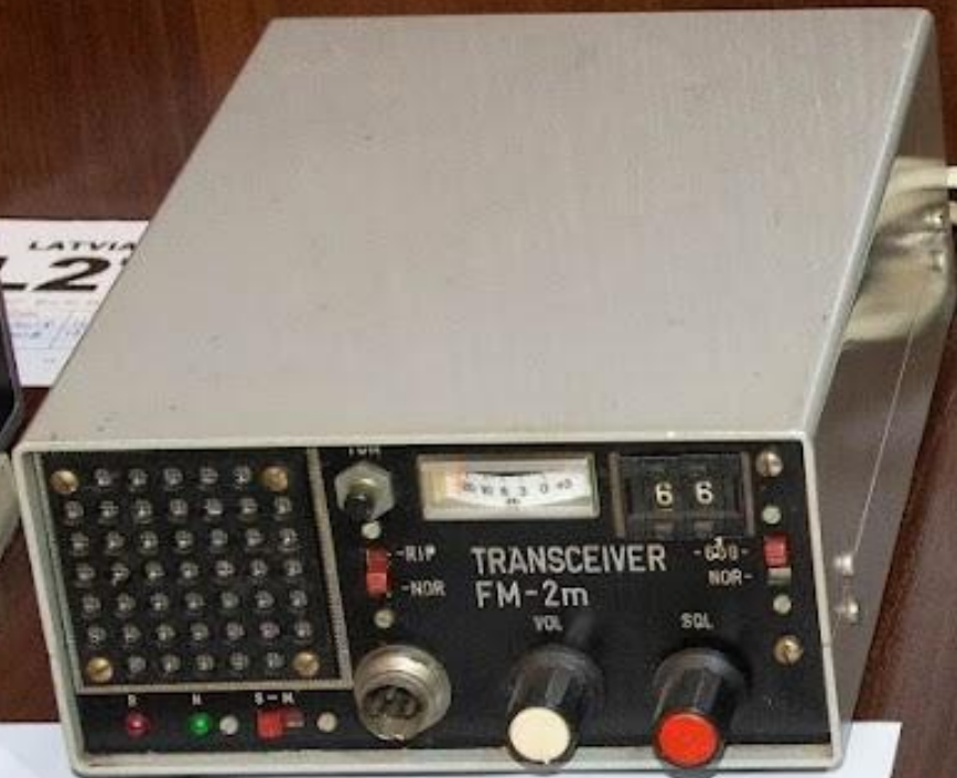
Radiotelefon FM-315 – koniec lat siedemdziesiątych początek osiemdziesiątych wykorzystywany przez radioamatorów do pracy na 144 MHz.
